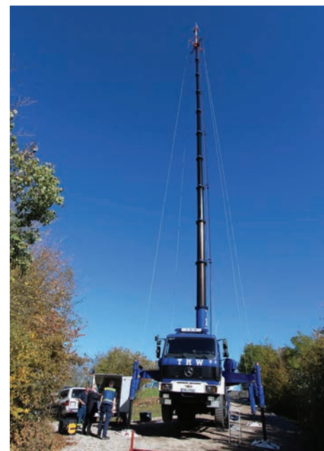
Mastkraftwagen mit 40 Meter hohem Antennenträger.
