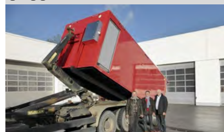
Absetzen des Abrollbehälters ist Teil der Baumusterprüfung
