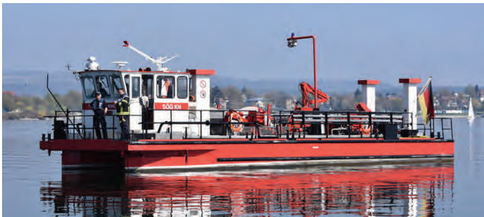
Das SÖG (selbstfahrendes Ölaufnahmeggerät) im Einsatz auf dem See
