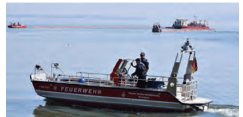
Ausbringen einer Ölsperre mit dem neuen Mehrzweckboot
